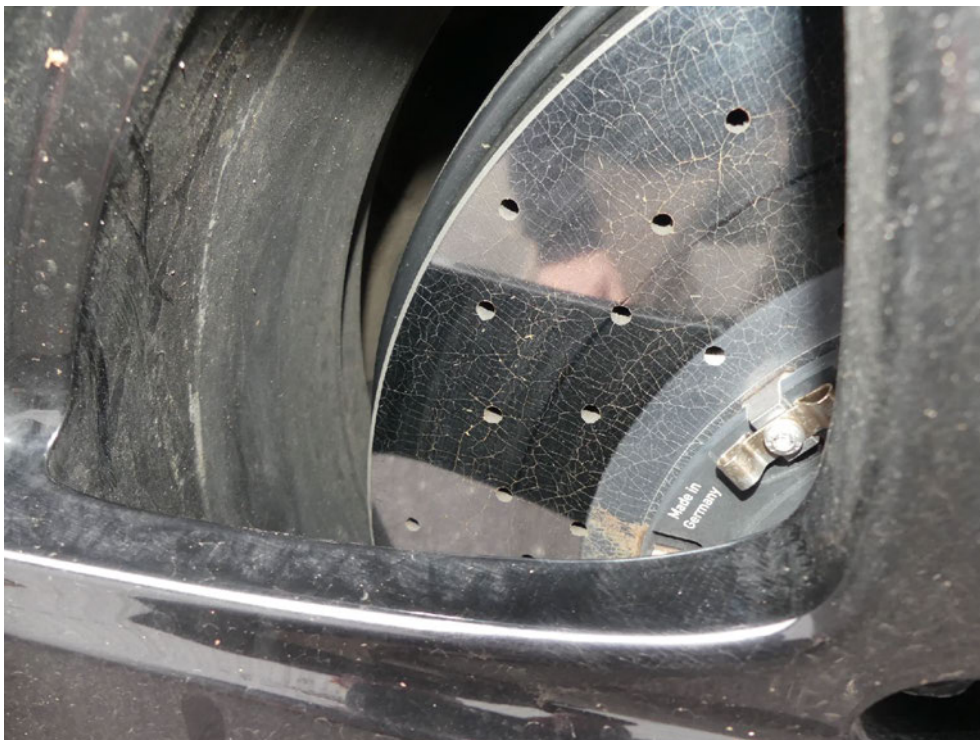
Bild: 46 PCCB - Porsche Ceramic Composite Brake (Keramikbremsanlage)
