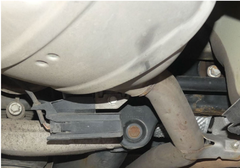
Bild: 53 Detailansicht Endschalldämpfer, dieser ist partiell deformiert.
