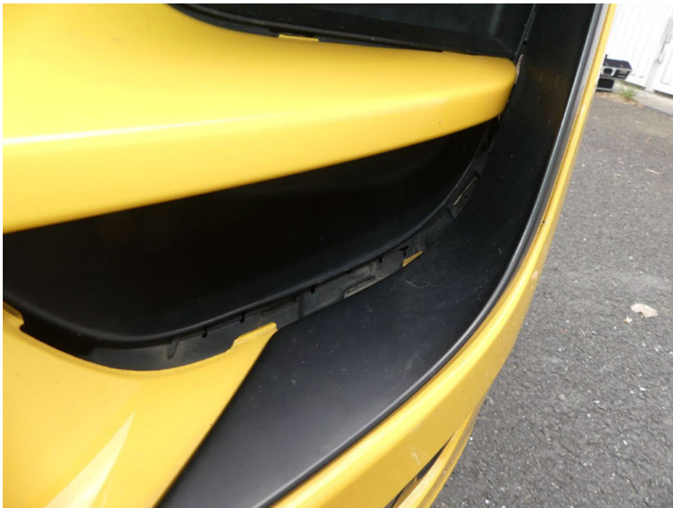
Bild: 69 Die Abdeckung ist lose und nach innen versetzt.
