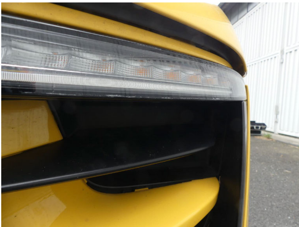
Bild: 70 Die Zusatzleuchte ist partiell abgetragen.
