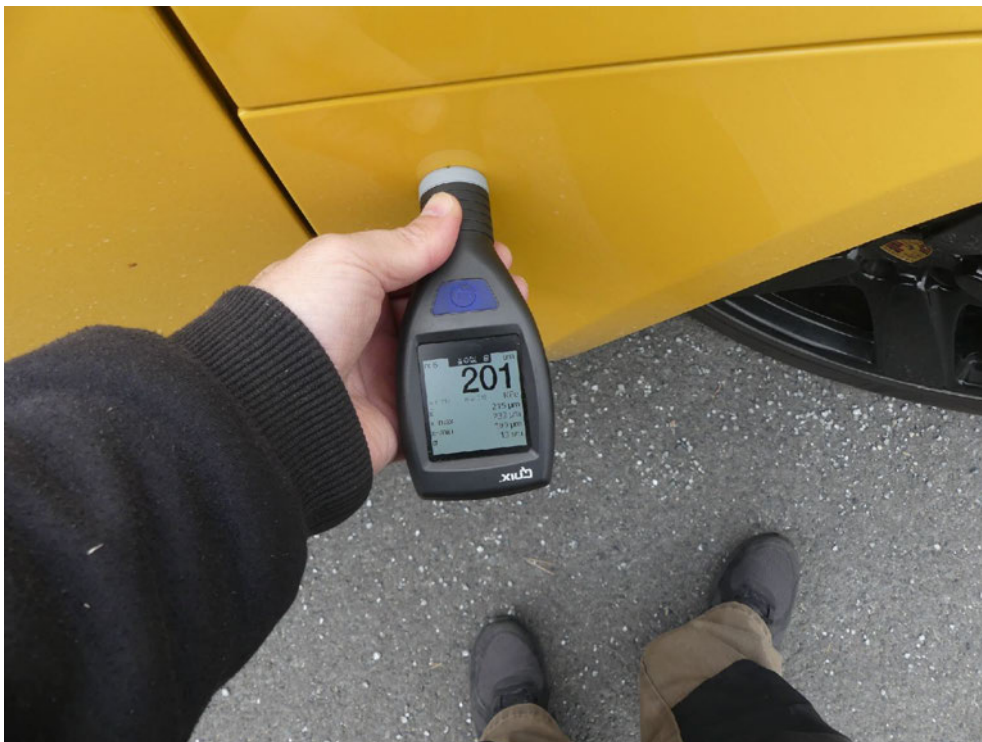
Bild: 60 Ausweisung Lackschichtdickenmessung vorgenommen, Messwerte dem beiliegenden Protokoll entnehmen.
