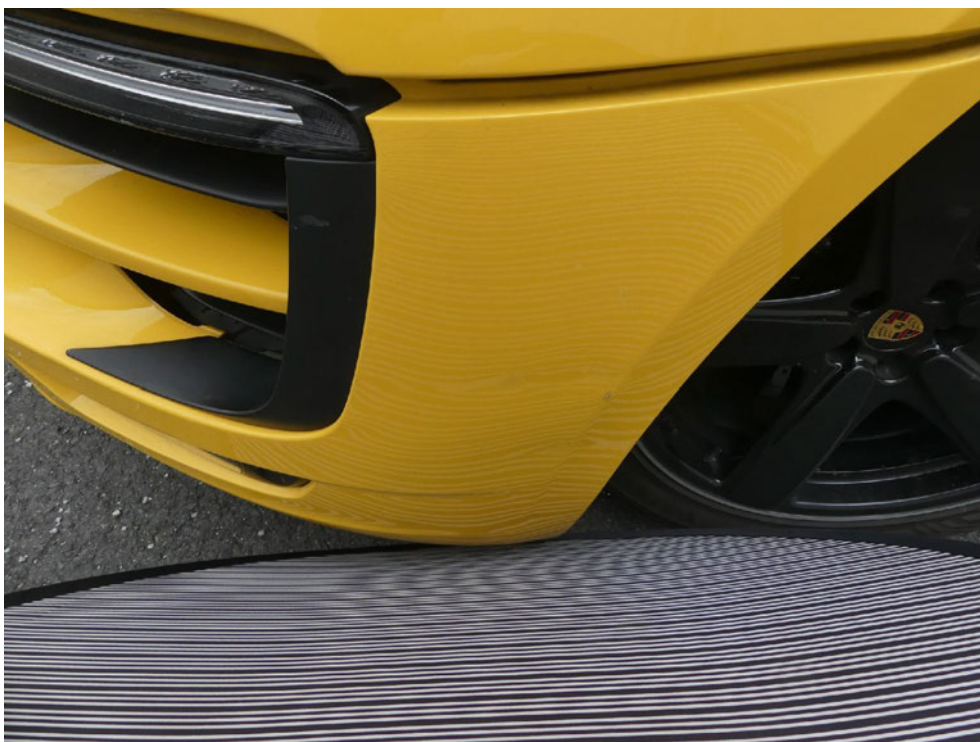
Bild: 64 Ansicht Frontverkleidung, diese ist überstreckt deformiert.
