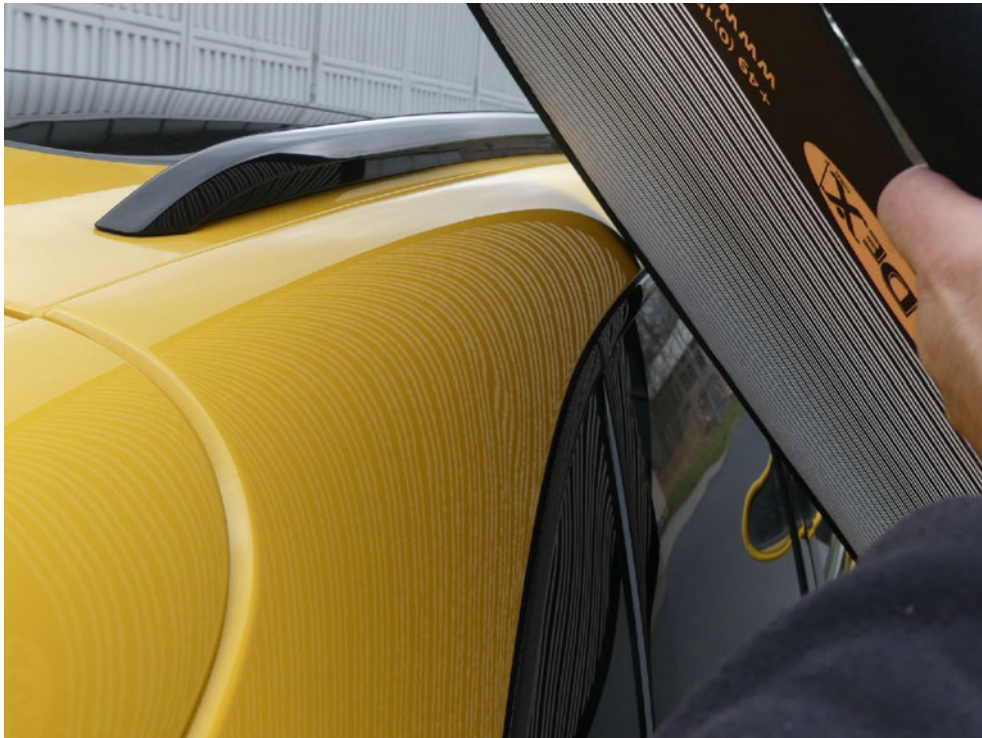
Bild: 73 Dachhol rechts hinten punktuell gestaucht.
