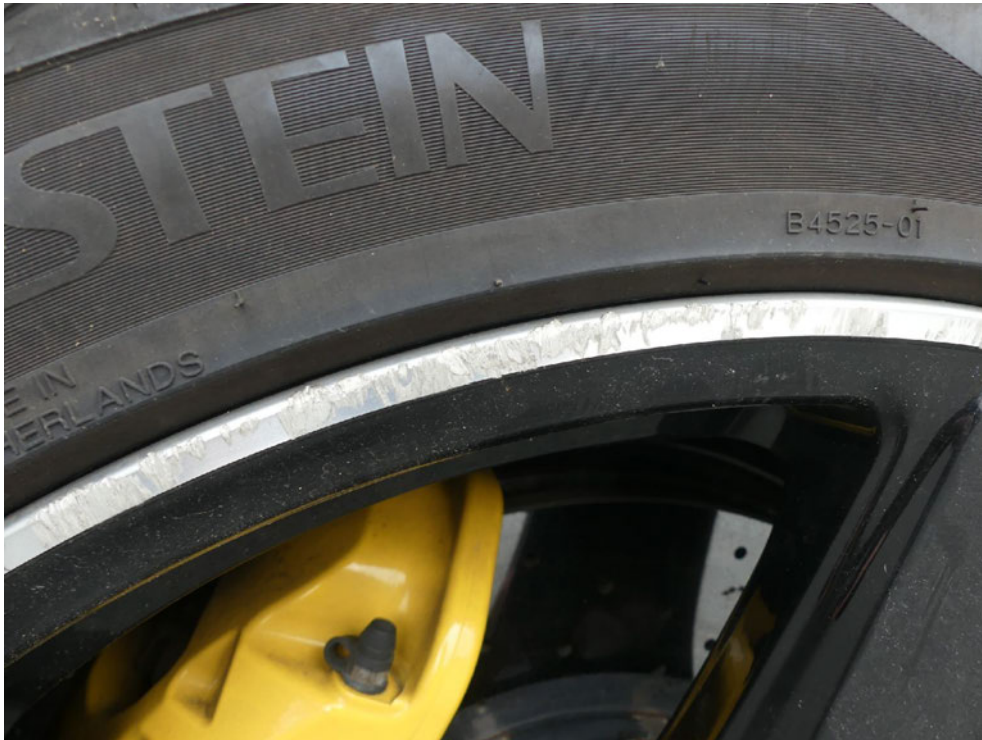
Bild: 51 LM-Felge vorn rechts ist sichtbar im Grundmaterial abgetragen.
