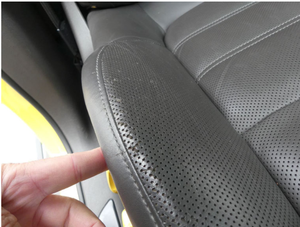
Bild: 43 Detailansicht Beifahrersitz mit Abnutzung Sitzwange rechts
