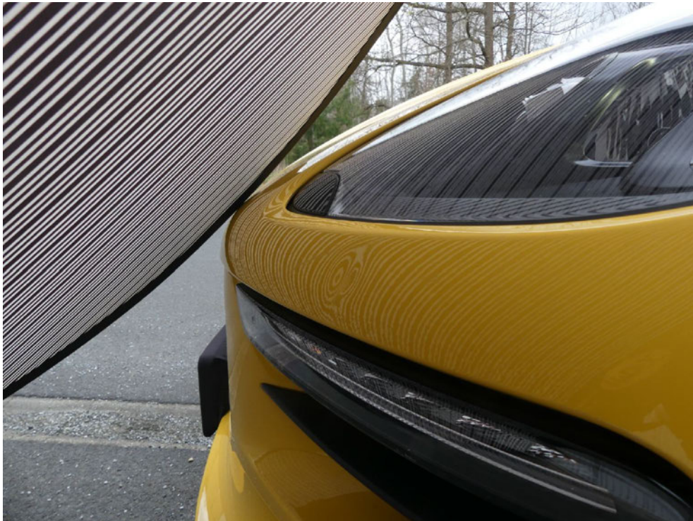
Bild: 67 Weiterführend ist die Fronverkleidung unterhalb des Hauptscheinwerfers bleibend gestaucht.
