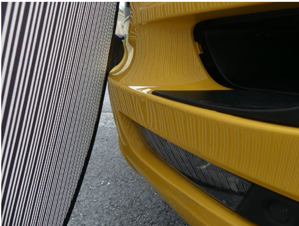
Bild: 72 Ausweisung weitere Materialdeformation der Frontverkleidung.
