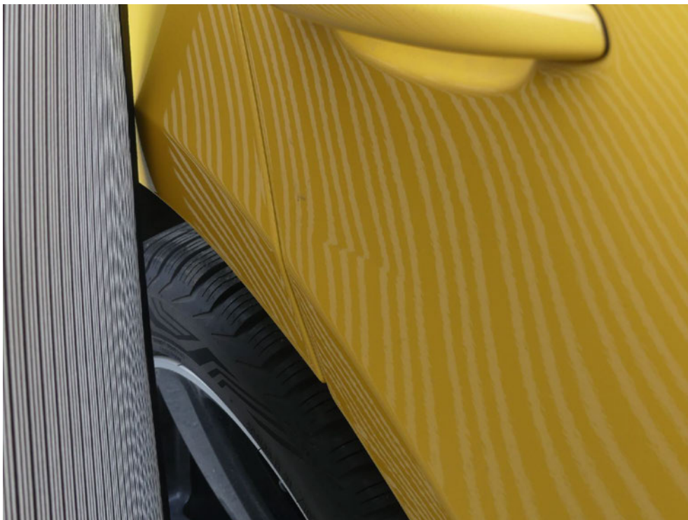
Bild: 74 Ansicht Fondtür rechts, diese ist partiell in der Türaußenhaut gestaucht.
