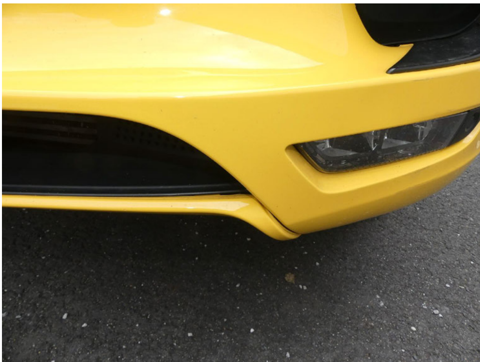
Bild: 68 Die Einbaulage der zum angrenzenden Spoilereinsatz ist versetzt.
